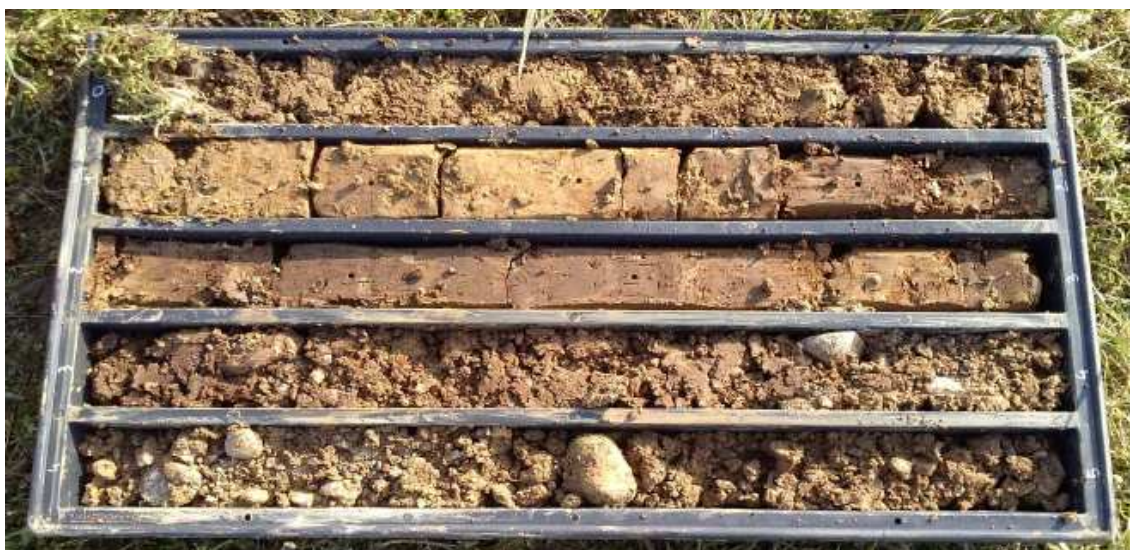
Fig. 11: S5 – cassa 1 (prof. 0-5 m. da p.c.): porzione superiore pedogenizzata con limi argillosi fino a 3 metri da p.c.
