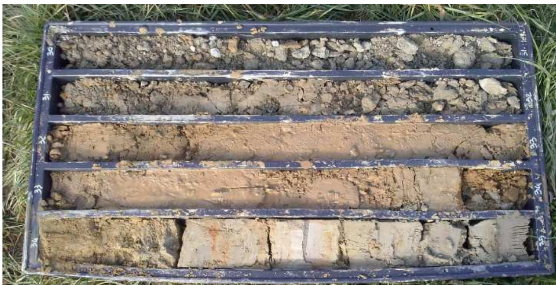
Fig. 9: S2 – cassa 7 (prof. 30-35 m. da p.c.): livelli di limi argillosi ed argilla
